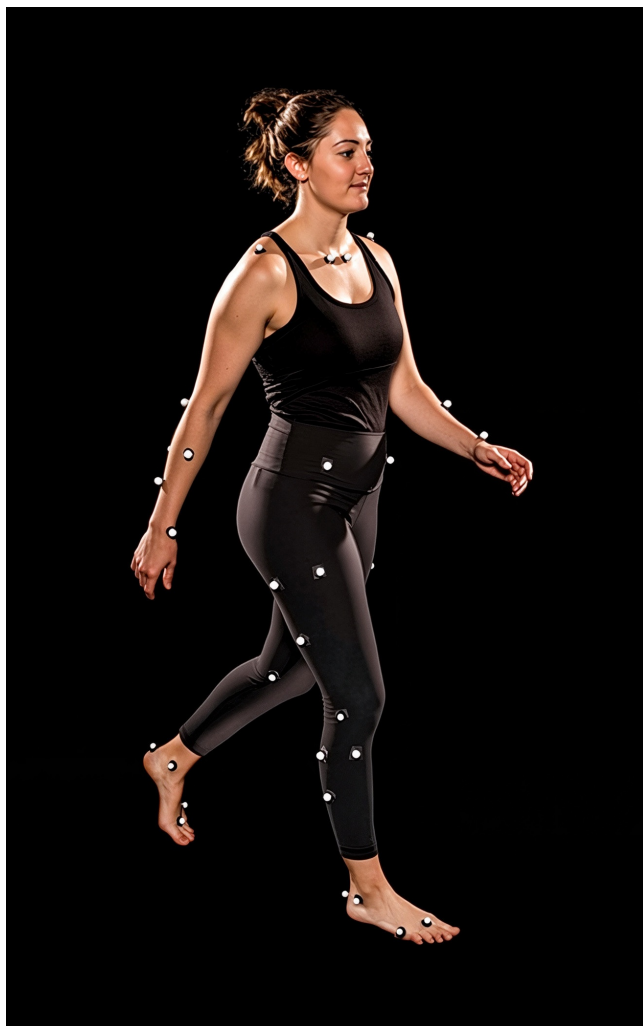
图 7.6: 光学运动捕捉 (mocap) 是一种流行的量化运动技术。我们可以通过皮肤上点的轨迹来估计底层骨骼的运动。
