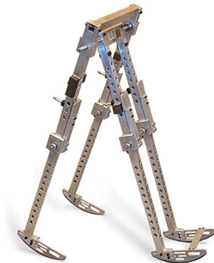
图 2.13: 塔德·麦吉尔 [7] 描述的步行机器的复制品。该装置包含两对腿，在给定正确的初始姿势和推力的情况下，能够沿着倾斜的表面行走。照片由史蒂夫·柯林斯提供。
