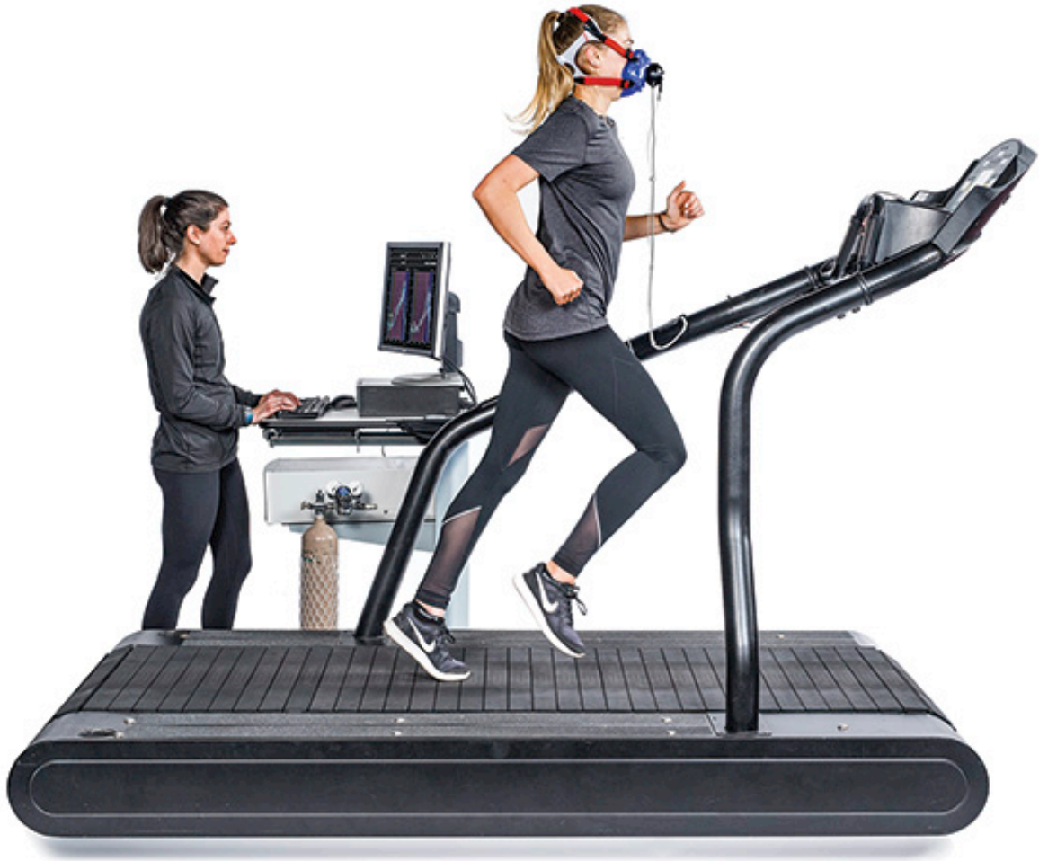
图 2.12: 测量氧气消耗量和二氧化碳生成量，以计算跑步过程中消耗的能量实验。该实验也用于计算步行过程中的运输成本，如图 2.11 所示。
