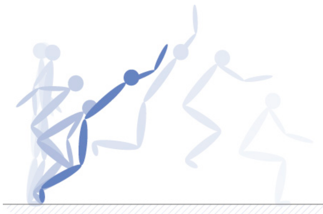
图 9.16: 一个包含五个段和七个自由度的平面模型，用于研究立定跳远过程中的肌肉协调性。采用动态优化方法预测踝关节、膝关节、髋关节和肩关节肌肉的协调性，以最大化跳跃距离 [67] 。
