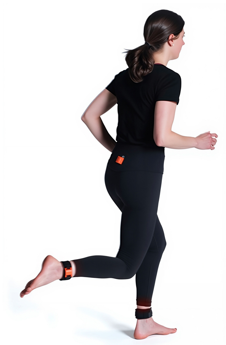
图 7.3: 惯性测量装置，即跑步者骨盆和脚踝上的橙色传感器，可以测量长跑过程中的线性加速度和角速度，以评估肌肉骨骼负荷。
