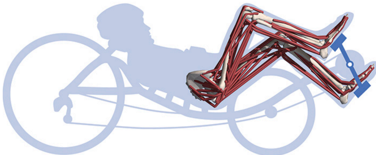
图 1.9: 用于调整肌肉兴奋模式以产生循环的肌肉驱动生物力学模型的示例。
